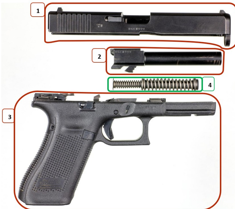
Abbildung 31: Glock 17, Hauptbestandteile der Pistole
