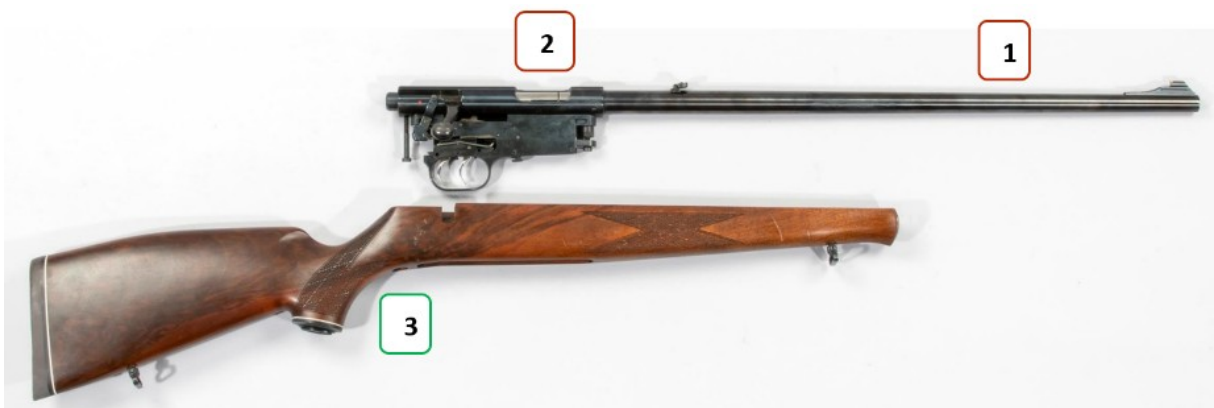
Abbildung 28: Repetierbüchse, Hauptbestandteile der Waffe
