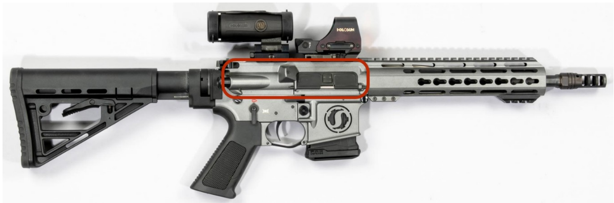
Abbildung 1: AR-15, Übersichtsaufnahme der Waffe, rote Markierung Gehäuseoberteil
