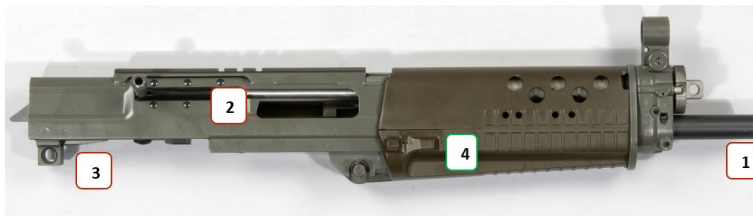
Abbildung 12: SIG-550, Gehäuse-Lauf-Einheit (GLE)
