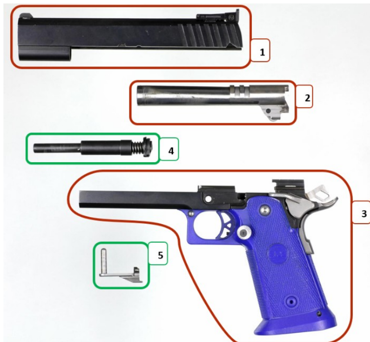
Abbildung 33: STI 2011, Hauptbestandteile der Pistole
