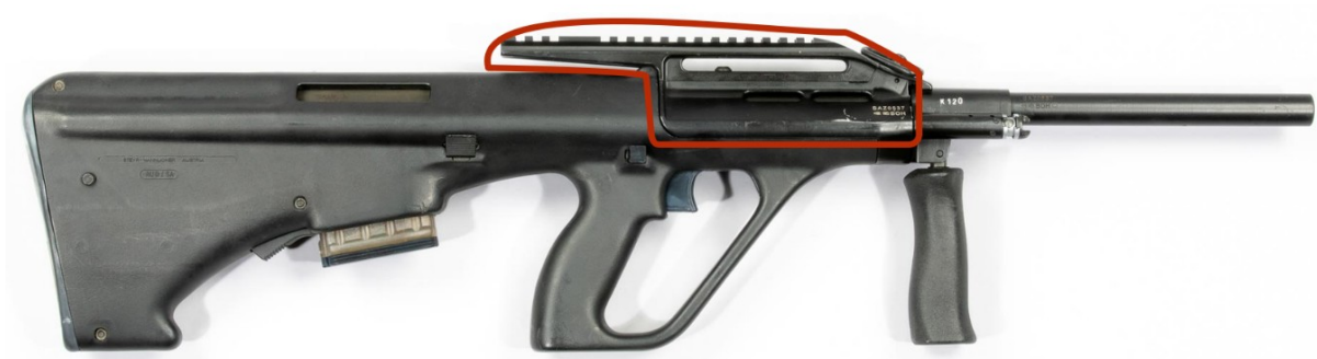
Abbildung 3: AUG Z, Übersichtsaufnahme der Waffe, rote Markierung Gehäuseoberteil ohne Optik
