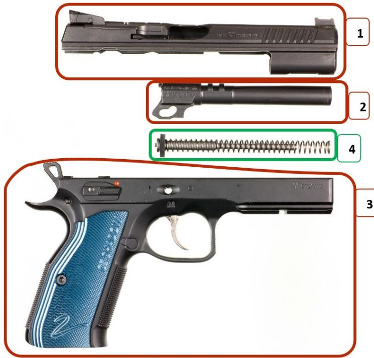
Abbildung 36: CZ-75, Hauptbestandteile der Pistole
