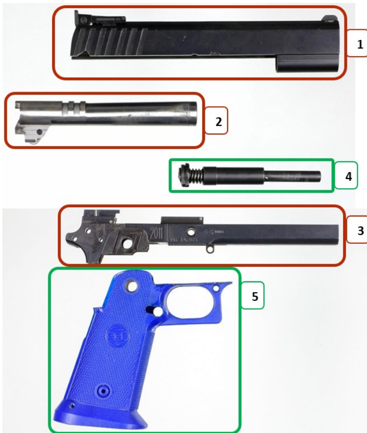
Abbildung 40: STI 2011, Hauptbestandteile der Pistole
